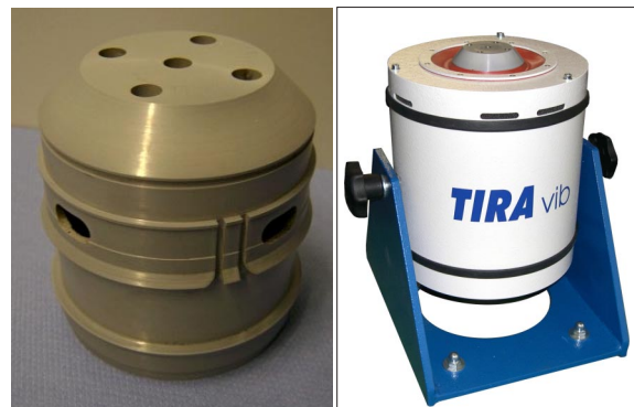
Bild 2 Kalibrierschwinger- kopf (25 kHz), dünnste Wandstärke ca. 0,3 mm
