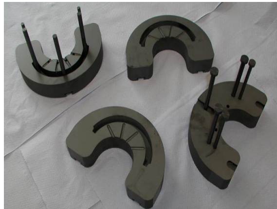
Bild 8 Spritzgusswerkzeug aus SiC
