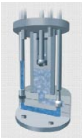
Bild 5 Funktionsprinzip- skizze und Keramik- bauteile der Schmelzepumpe
