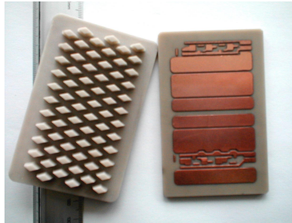
Bild 14 (links) PINFIN-Kühler für auf Kupfer montier- te Leistungshalblei- ter für Windkraftan- lagen
